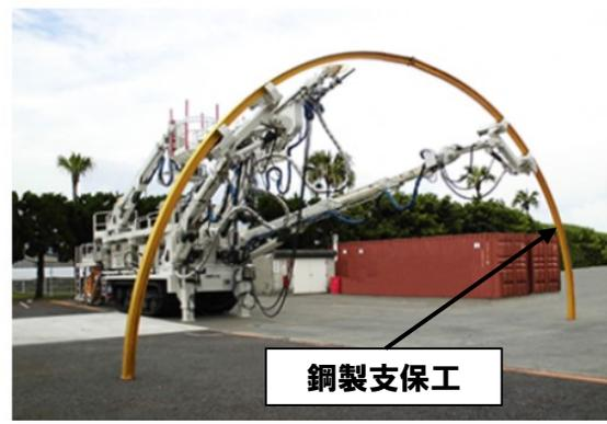
エレクター付コンクリート吹付け機は、発破した後の山肌へのコンクリートの吹付けと鋼製支保工の建込みを行う機械です。1つの機械で2つの作業ができるため、効率よく安全に作業を進めることができます。
